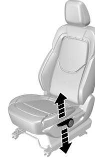
عند ضبط وضع وسادة مقعد السائق، ارفع أو أنزل المقبض الموجود على جانب وسادة المقعد حتى تتكيف مع الوضع المطلوب. عند ضبط ارتفاع مقعد السائق، يجب تحميل المقعد، وإلا فقد يتلف جهاز الضبط.
