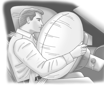
توجد الوسادة الهوائية الأمامية الخاصة بالسائق في منتصف عجلة القيادة.
