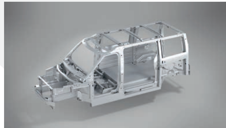
Construcción de aluminio sellado y anodizado mediante una técnica avanzada de producción empleada en el sector aeroespacial y de automovilismo de competición.
